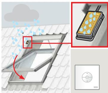
Pri aktivácii dažďového senzora sa strešné okno približne za 30 sekúnd automaticky zatvorí.
