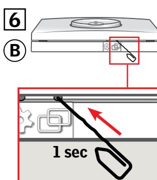
Registráciu výrobku vykonajte stlačením tlačidla PAIR na **(B)** na 1 sekundu.
