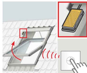
Okno možno znova otvoriť pomocou ovládacieho spínača, keď je dažďový senzor suchý.
