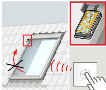
Ak zaregistruje dážď, dažďový senzor zabráňuje otvoreniu strešného okna na.
